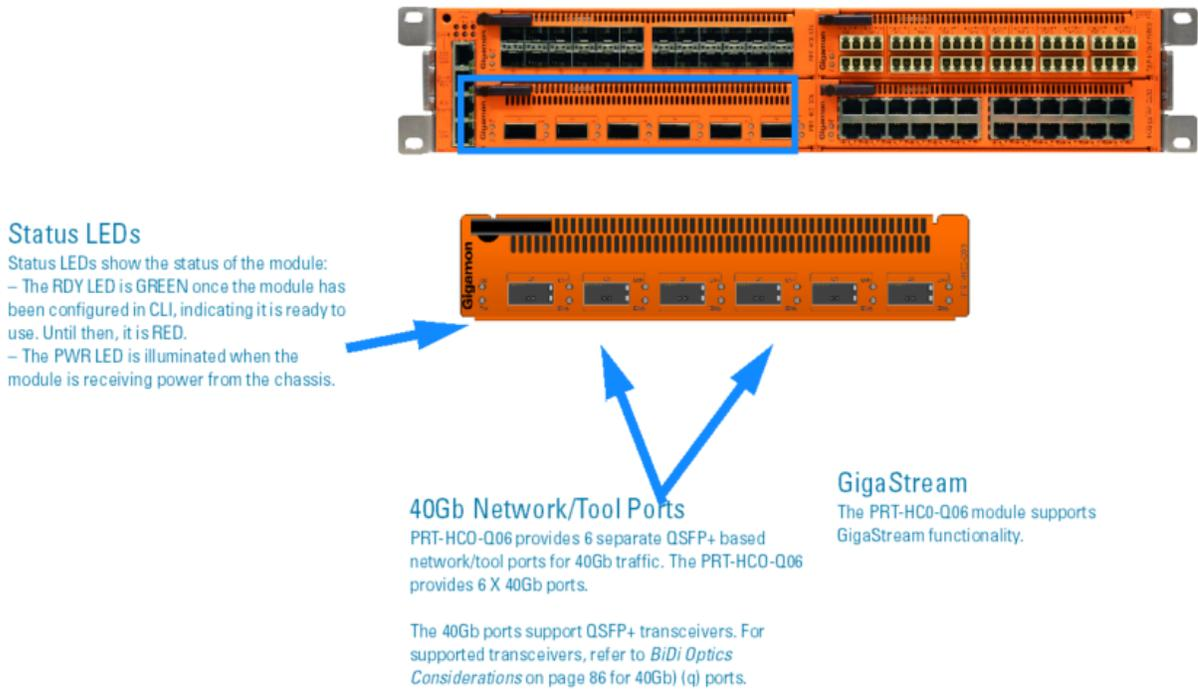
**Figure 5** PRT-HC0-Q06 Module
